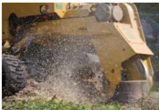
Breitreifen mit Industrieprofil, Zwillingsreifen und Allradantrieb garantieren der RG 45 auch unter schwersten Bedingungen beste Traktion. Ein hydraulisches Schiebeschild minimiert Aufräumarbeiten und RAYCOs Command Cut schützt die Maschine zuverlässig vor Überbelastungen. Alles verbaut in einer hydraulisch geschwenkten Wurzelfräse, die mit nur 309 cm Länge die kompakteste Maschine dieser Klasse am Markt darstellt.
