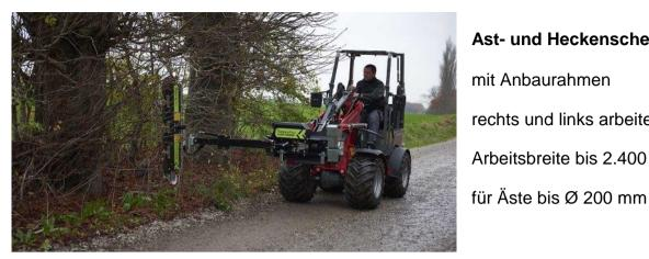
**Ast- und Heckenschere** mit Anbaurahmen rechts und links arbeitend Arbeitsbreite bis 2.400 mm
