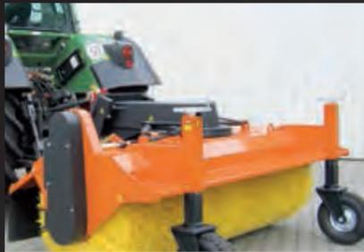
**bema Jumbo** mit Schlepperanbau Heck; angetrieben mechanisch.
