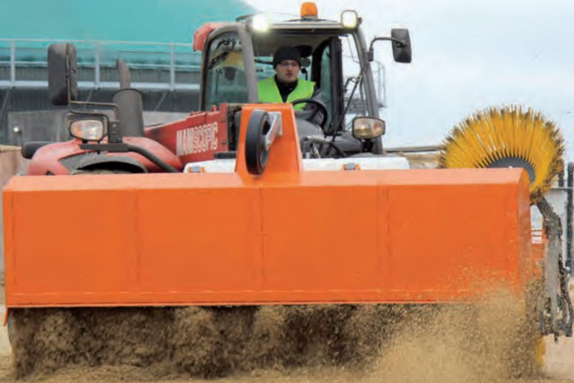
**bema 30 Dual** mit Seitenkehrbesen und Wassersprueheinrichtung.
