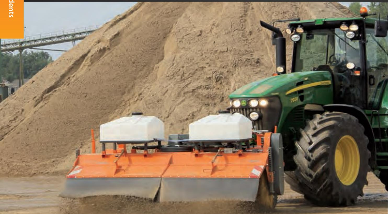
**bema Jumbo** am Schlepper mit Front Dreipunktanbau.
