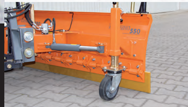
Variante 1: Schneeschild mit Federklappen und Laufrädern.
