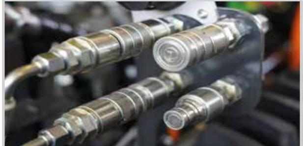
Weiterer Hydraulikanschluss für hydr. Zusatzfunktionen (doppelt wirkend)
