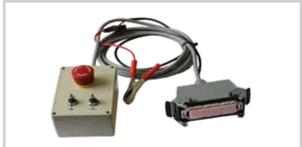
Manuelle Steuerung der Raupe bei komplettem Systemausfall in extremer Not-Situation
