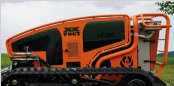
**Kettenschutz / Steinschlagschutz**
