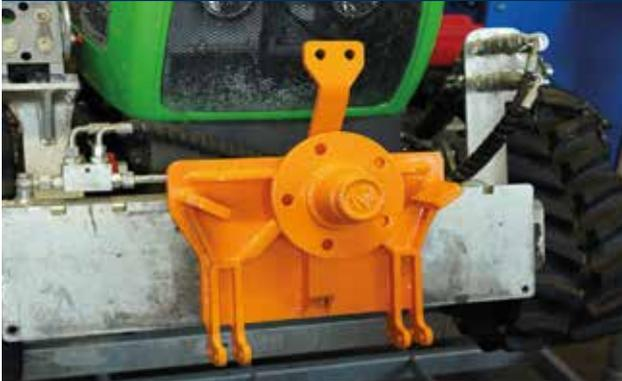
Hydr. Zapfwellenmotor (540-1000 U/min)
